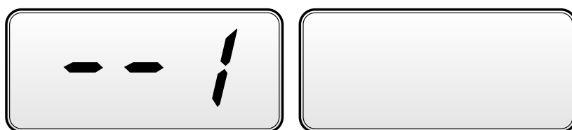
Figura 6.13 Busca de faces de balanceamento: a tela esquerda indica a retirada do sensor (movendo-o para a direita) para encontrar a posição exata da face de balanceamento interno
