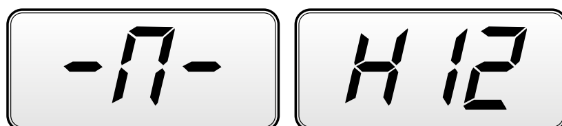
Figura 8.3 Mensagem "Trazer a válvula (bico de enchimento) até a posição de 12 horas"
