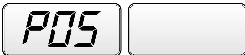
Figura 6.15 Busca de faces de balanceamento: a tela esquerda indica que o sensor está exatamente na face de balanceamento interno
