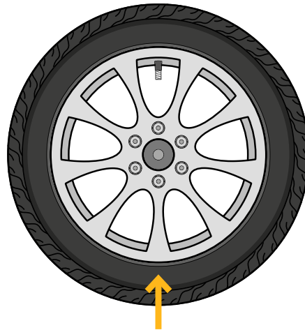
Figura 8.6 Marcação do pneu a 180° em relação à válvula
