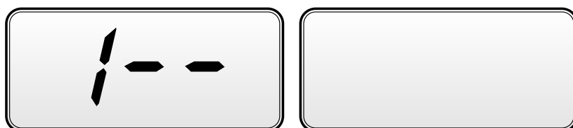
Figura 6.14 Busca de faces de balanceamento: a tela esquerda indica a reintrodução do sensor (movendo-o para a esquerda) para encontrar a posição exata da face de balanceamento interno.
