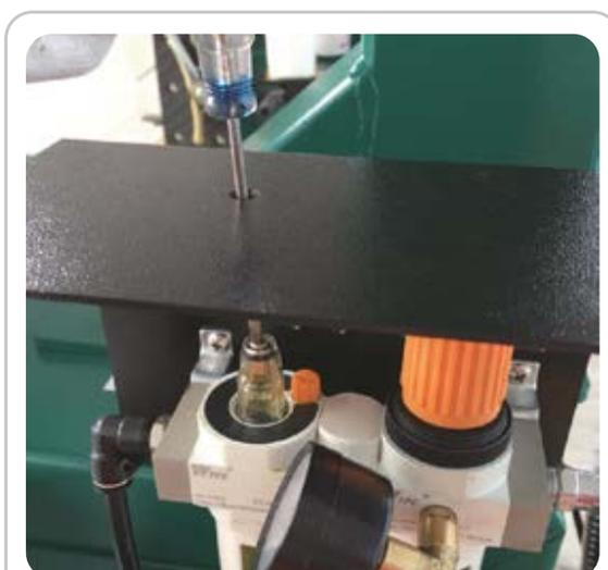
Verifique a lubrificação diariamente para garantir que o óleo lubrificante está caindo no lubrificador de óleo após pisar no pedal. Ajuste o parafuso no lubrificador de óleo com uma chave quando necessário.
