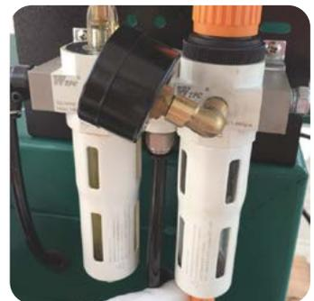
Verifique regularmente o nível de água do regulador, não deve ser superior a 50% de altura, gire o botão de travamento quando necessário. Drenagem manual
