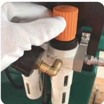
Gire para ajustar a pressão, faixa de ajuste de pressão é 8 a 10 bar
