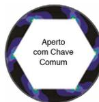
**Aperto com soquete comum:** Forças concentradas em pequenos pontos favorecem o surgimento de trincas, diminuem a vida útil dos soquetes e espanam porcas e parafusos.
