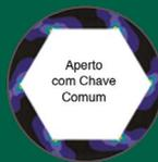
**Chave comum:** Forças concentradas em pequenos pontos favorecem o surgimento de trincas, diminuem a vida útil da chave e espanam porcas e parafusos.
